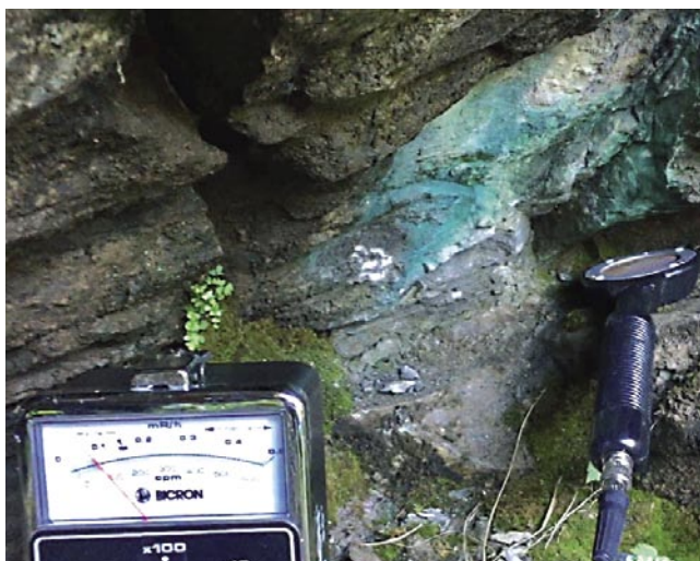
Fig. 8 - Misura della radioattività con il contatore a scintillazione. - Measurement of radioactivity with the sparking Counter.
