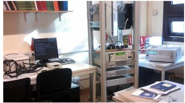
Fig. 6. Montaje experimental de la micro-red mostrada en la figura 5. A la izquierda se puede apreciar el conjunto de monitorización y control basado en PXI, y a la derecha el rack con los componentes de la micro-red de la figura anterior.
