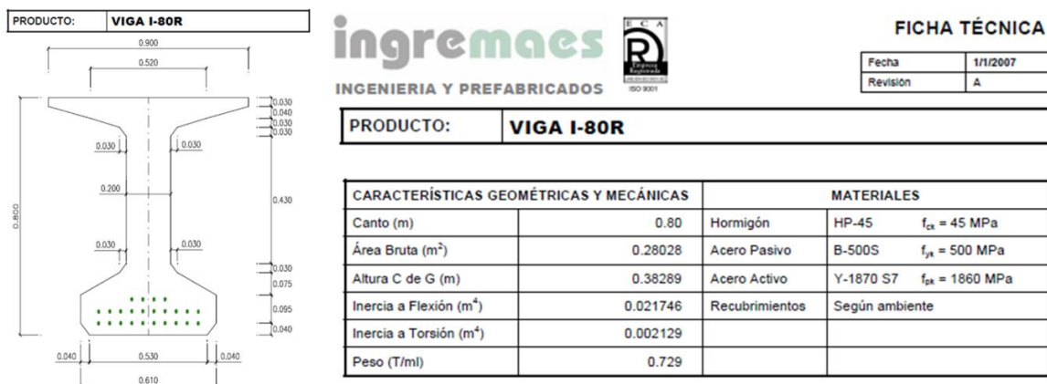
Figura 30. Características de la viga I-80R proporcionados por la empresa ingremaes.
