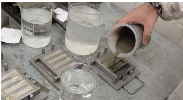
Figura 3-5. Proceso de versado de la mezcla.
