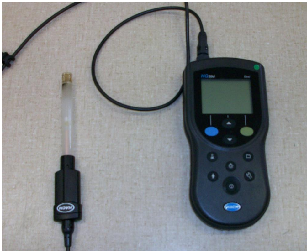
Fig.3.2.: HACH HQ30d pH monitor
