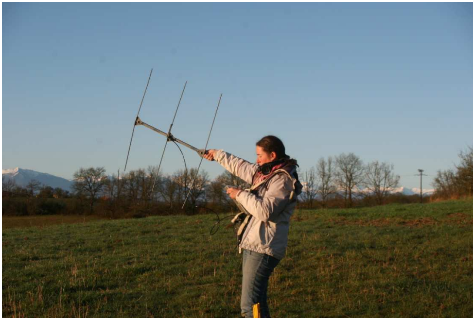
Antenne et récepteur permettant de localiser un individu équipé d'un collier GPS ou VHF grâce à l'émetteur VHF.
