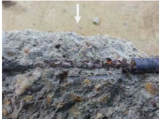
Figure G.B : État de surface des armatures après les essais d'aspersion d'ions chlorure (F2-11, F2-12 et F2-13)
