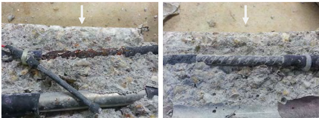
Figure G.A : État de surface des armatures après les essais d'aspersion d'ions chlorure (F1-11, F1-12 et F1-13)
