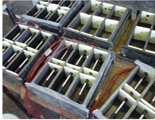
Figure 2.3 : Préparation des moules 70 x 70 x 280 (mm) pour la fabrication des éprouvettes armées 70 x 70 x 110 (mm).
