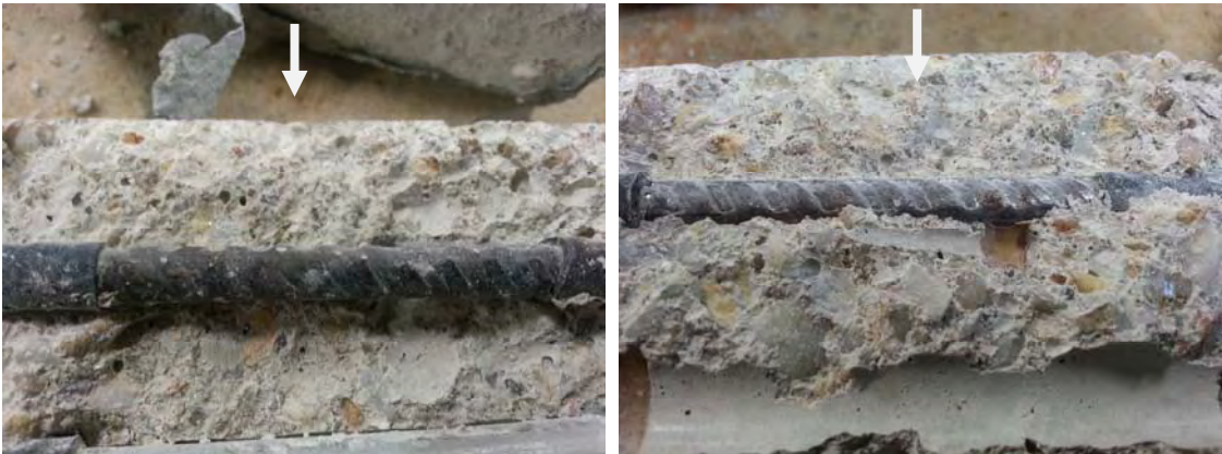
Figure 2.33 : Etat de surface des armatures après les essais de carbonatation accélérée (F3-6, F3-7 et F3-8).
