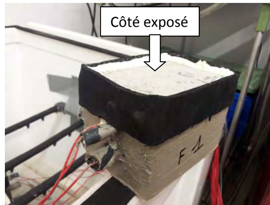
Figure 2.27 : Exemple d'une éprouvette prismatique 70 x 70 x 110 (mm).
