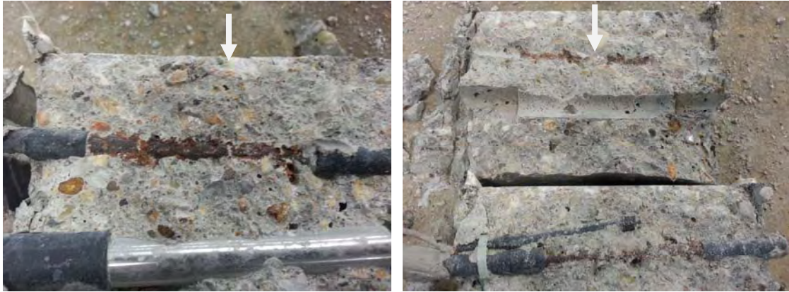
Figure H.A : État de surface des armatures après les essais de carbonatation accélérée couplés à la diffusion des ions chlorure par aspersion (F1-17, F1-18)
