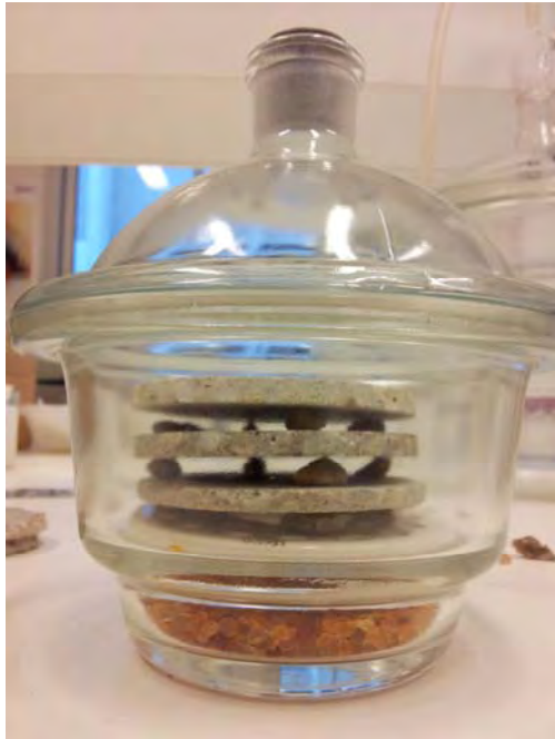
Figure 2.10 : Essai de sorption/désorption : dessiccateur d'essai contenant 3 corps d'épreuve et des sels pour réguler l'humidité relative (à gauche), dimensions des éprouvettes testées (à droite).
