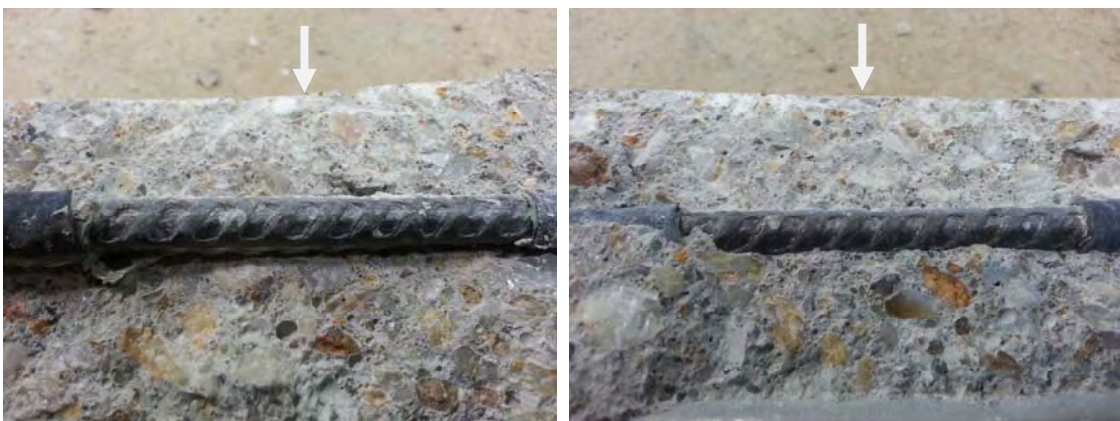
Figure 2.31 : Etat de surface des armatures après les essais de carbonatation accélérée (F1-6 et F1-7).
