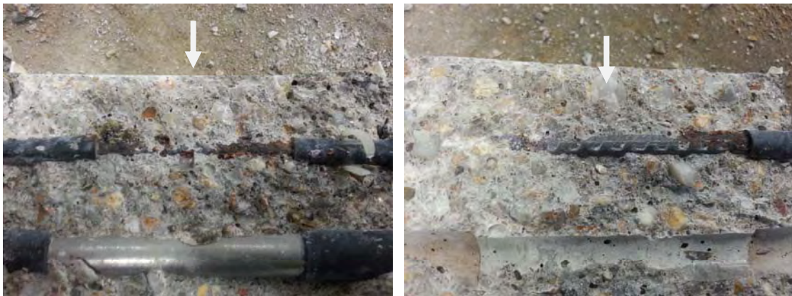
Figure H.A : État de surface des armatures après les essais de carbonatation accélérée couplés à la diffusion des ions chlorure par aspersion (F1-17, F1-18)
