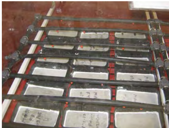
Figure 2.42 : Système d'aspersion utilisé pour les cycles d'humidification/séchage.
