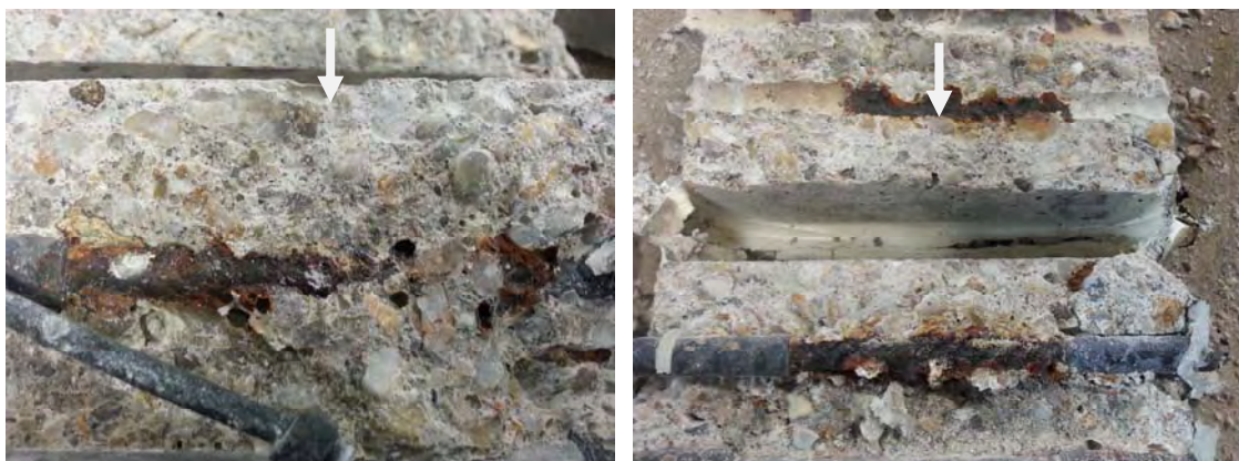
Figure H.C : État de surface des armatures après les essais de carbonatation accélérée couplés à la diffusion des ions chlorure par aspersion (F3-16, F3-17, F3-18)
