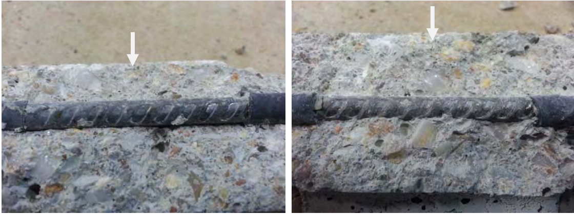
Figure 2.31 : Etat de surface des armatures après les essais de carbonatation accélérée (F1-6 et F1-7).
