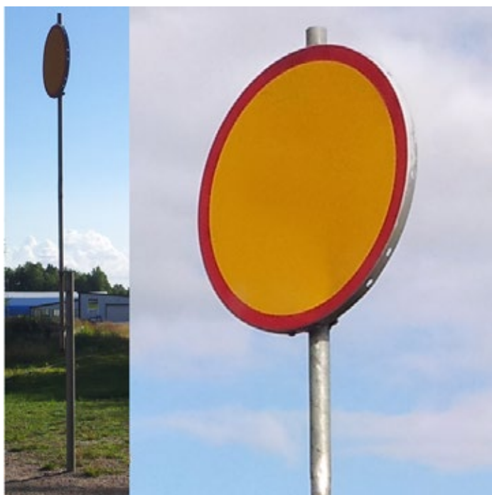
Semaför, s.k. plåstins, som med gult fält i mitten omgärdat av en röd ring kan vändas åt båda riktningar för att på håll signalera till lokförare ifall de ska stanna eller kan köra förbi station där järnvägen är enkelspärig.
