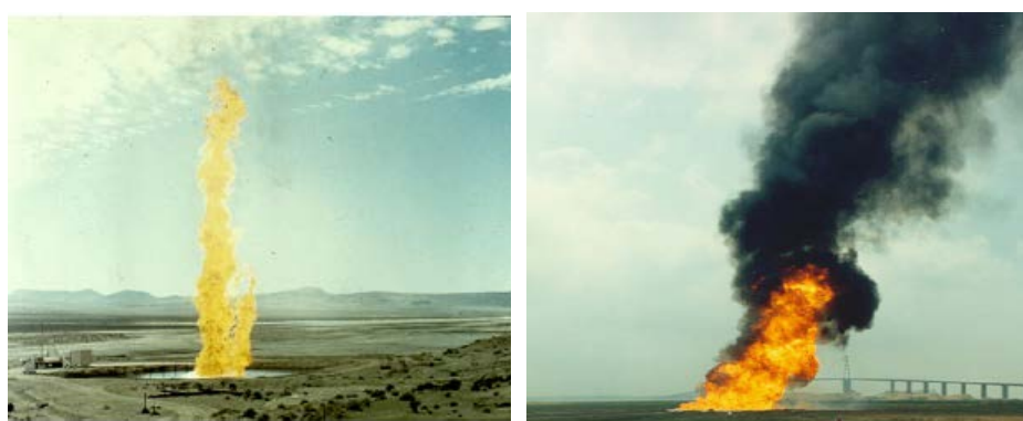
左图：1974-1976 年美国 China Lake 实验 [105] LNG 池火直径 15m，水池尺寸 50\text{m}\times 50\text{m}\times 1\text{m} ； 右图：1987 年 法国 Montoir 实验 [112] LNG 池火直径 35m，地面围堰内泄漏
