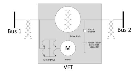
Figure 33: Variable frequency transformer (VFT).
