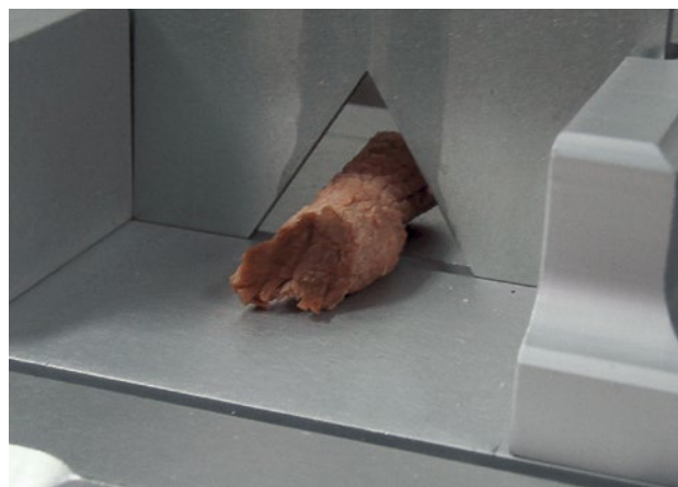
Abb. 2 | Bestimmung der maximalen Scherkraft des Lammfleisches (Indikator für Zartheit) im Labor. (Foto: Helen Willems)
