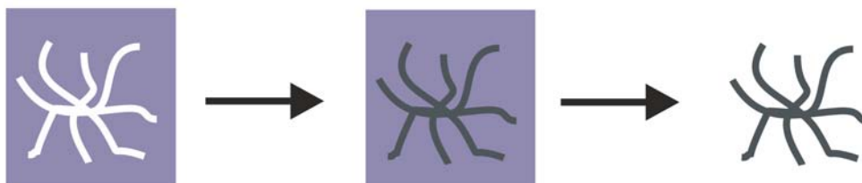
Abbildung I.2.1.: Schematische Darstellung der Abgrenzung der Endo- und Exotemplatmethoden nach Schüth [48]. Im oberen Bild ist die Endotemplatmethode dargestellt. Bei dieser Methode wird das formgebende Material (Endotemplat) von der das Produkt bildenden Substanz umschlossen und bildet somit eine Matrix für den Aufbau des Produkts. Die untere Abbildung zeigt schematisch den Verlauf des Exotemplatverfahrens. Hierbei werden poröse Materialien als Template verwendet und darin die Produktmaterialien abgeschieden. Wobei das aussenliegende Templat nach der Abscheidung entfernt wird um das Negativabbild des Templats freizulegen.
