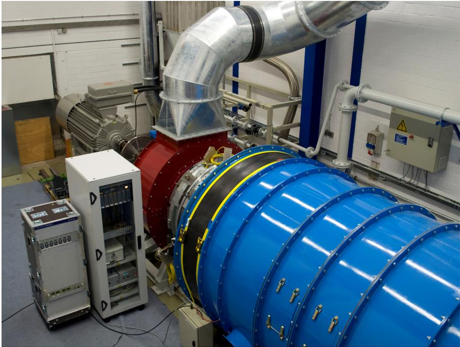
**Abbildung A.2.:** Foto des Turbinenprüfstandes. Im Vordergrund die blaue Beruhigungskammer, in roter Farbe das Abströmgehäuse. Dazwischen befindet sich die Turbine, jedoch ohne Messtechnik. Die Messaufnehmer und Steuerung der Messtechnik befindet sich in den beiden 19-Zoll-Schränken links neben der Turbine. Im Hintergrund der graue Bremsgenerator.
