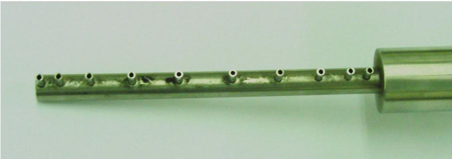
*Abbildung 4.5.: eine der verwendeten Kammsonden*
