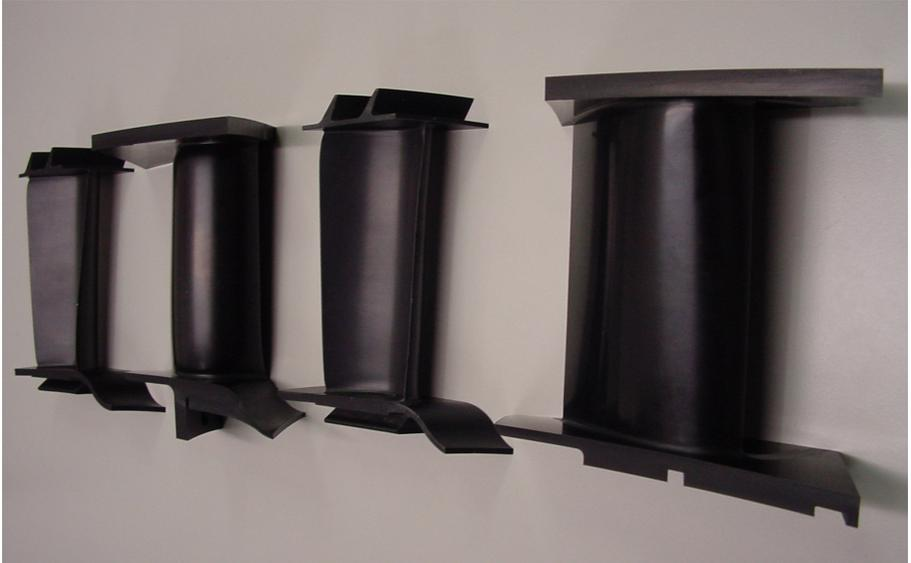
**Abbildung A.1.:** Foto der MAGPI-Beschaufelung. Im Vordergrund rechts ist Stator 1 zu sehen, gefolgt von Rotor 1, Stator 2 und im Hintergrund links Rotor 2. Die Rotoren haben ein Deckband. Das Material ist ein faserverstärkter Kunststoff. Die Geometrien der Rim Seals sind gut zu erkennen.
