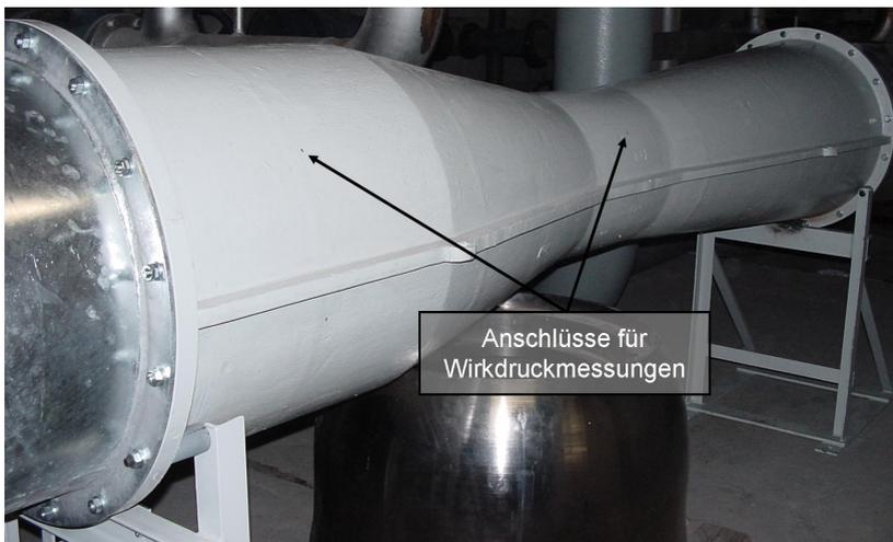
*Abbildung 4.4.: Das verwendete Venturirohr zur Messung des Hauptmassenstromes*
