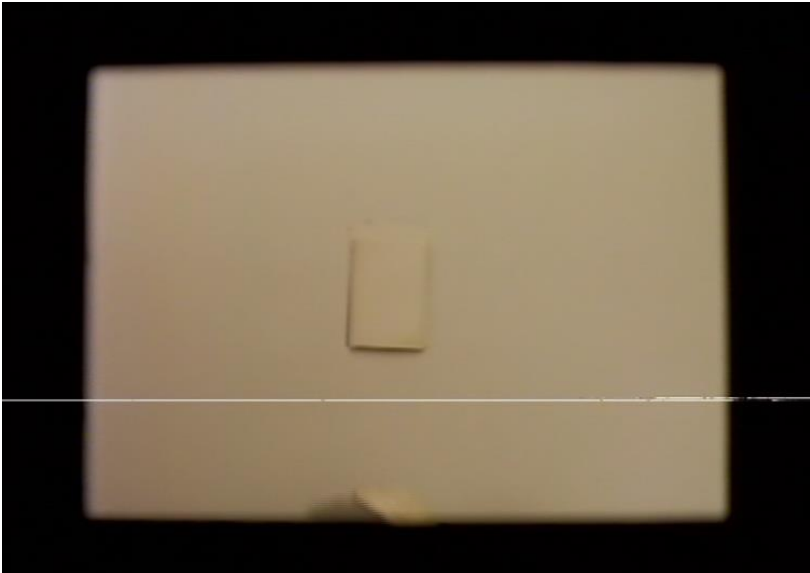
Abbildung 4: Durch Verschmutzung der Videoköpfes verursachter Drop-Out 40
