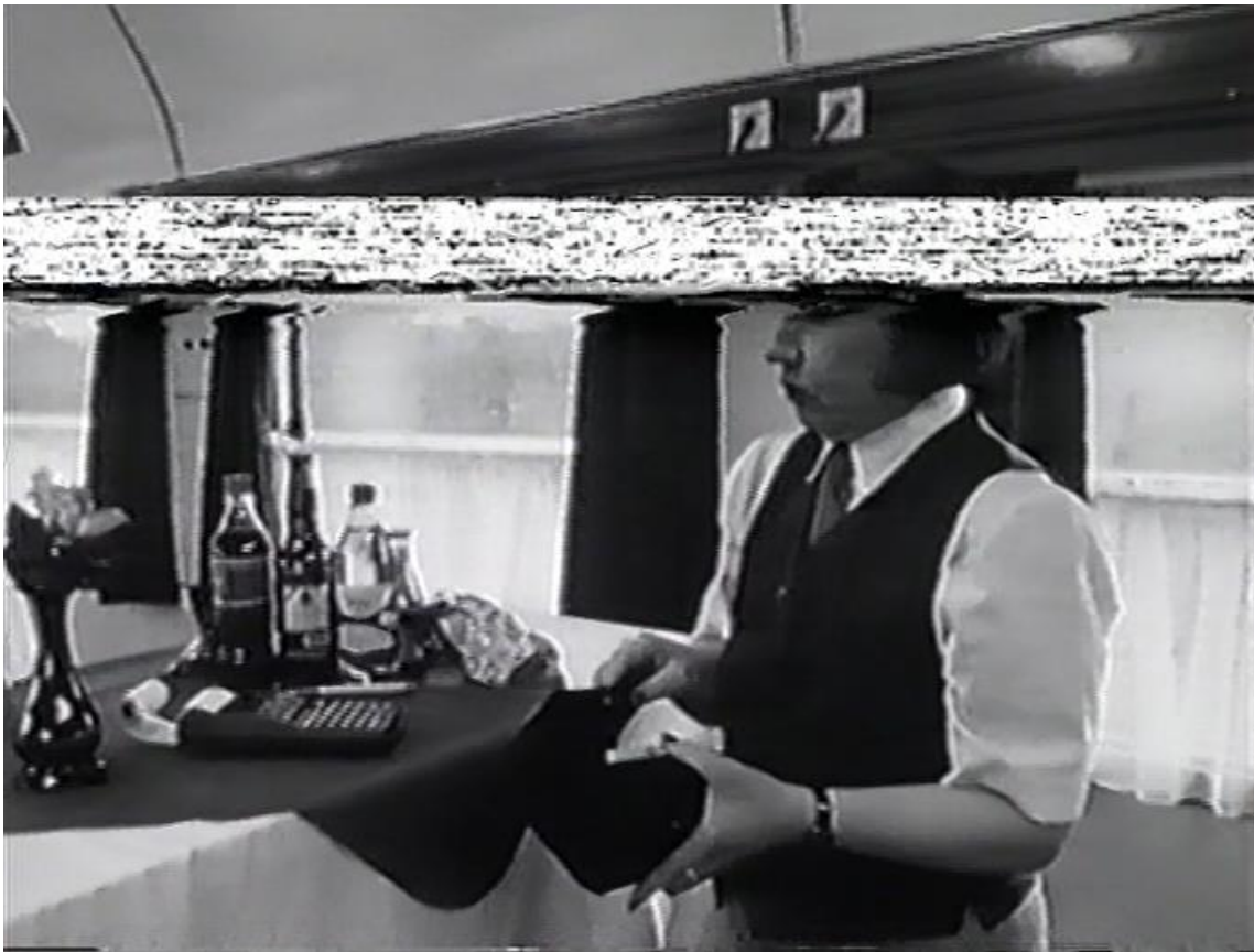
Abbildung 5: Durch Knick im Videoband verursachter horizontaler Störstreifen, der von oben nach unten durch das Bild läuft 54
