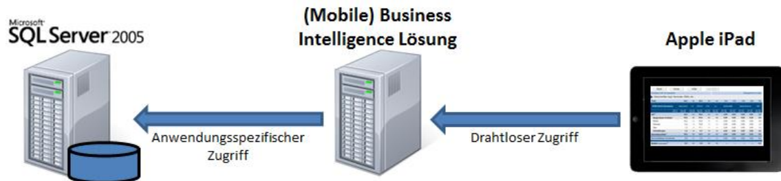
Abbildung 7: Architekturvariante 1 - Standalone Lösung
