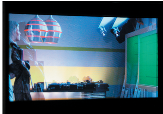
ABB. 5.4 Blick in den 3D Viewer Mithilfe einer Polarisationsbrille können die stereoskopischen Parameter vor Ort überprüft werden
