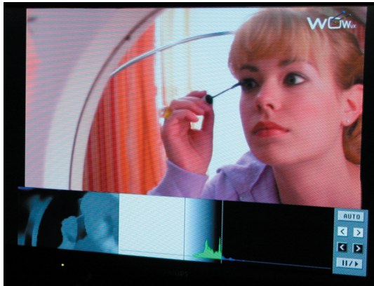
ABB. 5.8 Philips Display Deutlich zu sehen die Tiefenmap und die Verteilung der Objekte im Grauskalenspektrum / Raum
