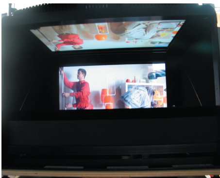
ABB. 5.3 3D Viewer bestehend aus 2 LCDs und einem halbdurchlässigen Spiegel Das Kamerasignal der senkrecht stehenden Kamera ist noch nicht gedreht
