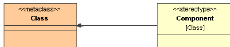
Abbildung 3. 8: Definition eines Stereotypen in UML 2.0
