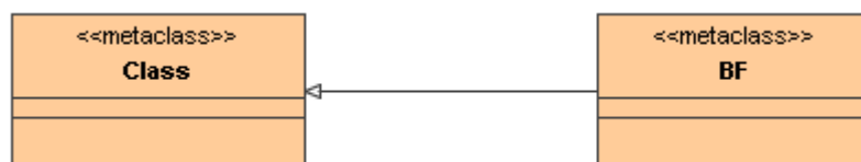
Abbildung 3. 7: Definition Stereotype nach UML 1.x
