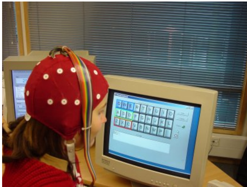
Abbildung 28: Virtuelle Tastatur mit Brain-Interface [75]
