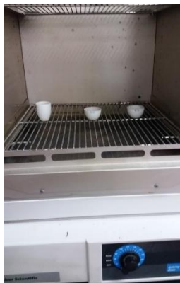
Figura 2.8 Determinación de la humedad por triplicado
