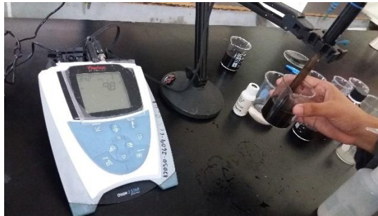
Figura 2.14 Determinación del pH del carbón activado elaborado en el laboratorio
