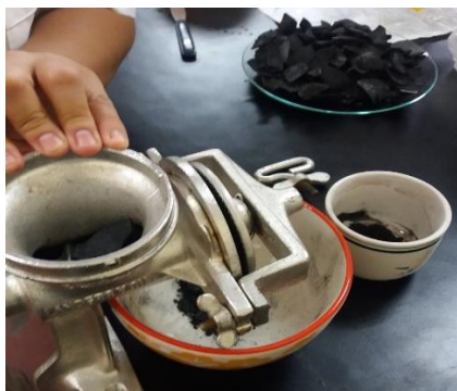
Figura 2.7 Reducción de tamaño del carbón activado obtenido en el laboratorio
