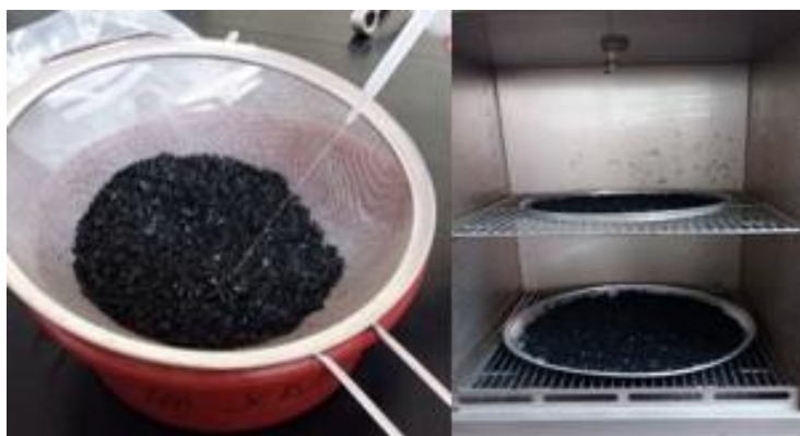
Figura 2.15 Lavado y secado de carbón activado obtenido en el laboratorio
