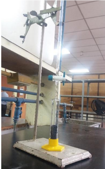
Figura 2.10 Montaje para prueba de porosidad
