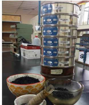
Figura 2.11 Montaje de tamices U.S. Standard Sieve para clasificación granulométrica del carbón activado
