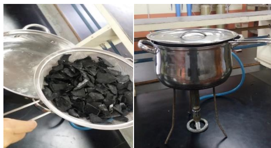
Figura 2.4 Proceso de activación del carbón obtenido en el laboratorio
