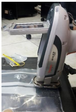
Figura 2.12 Realización de análisis FRX sobre carbón activado
