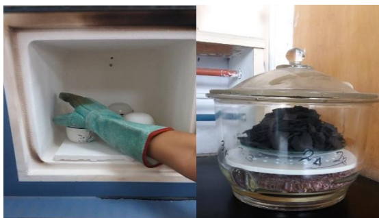
Figura 2.3 Proceso de carbonización y obtención de material carbonizado a partir de concha de coco
