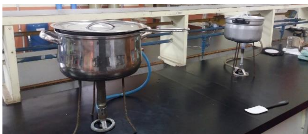
Figura 2.5 Montaje del equipo para el proceso de activación del carbón obtenido en el laboratorio
