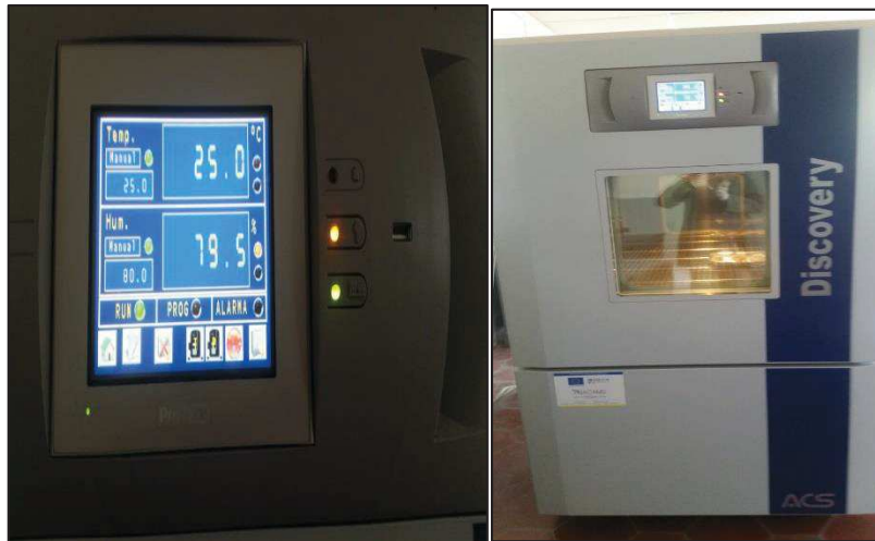
Figura 4.2 Cámara de humedad relativa, utilizada para ensayos de vida de anaquel, realizado en la Planta Piloto de Ingeniería Química de la Facultad de Ingeniería y Arquitectura.
