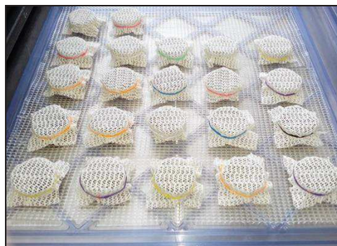
Figura 3.2 Colocación de malla de protección a las charolas que contienen las muestras de hoja de chaya.
