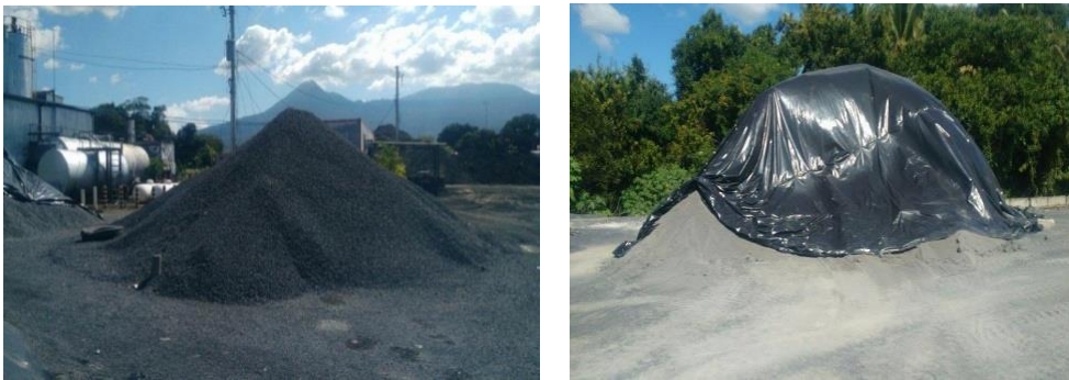
FIGURA 2.9 –Acopio de agregado pétreo.
