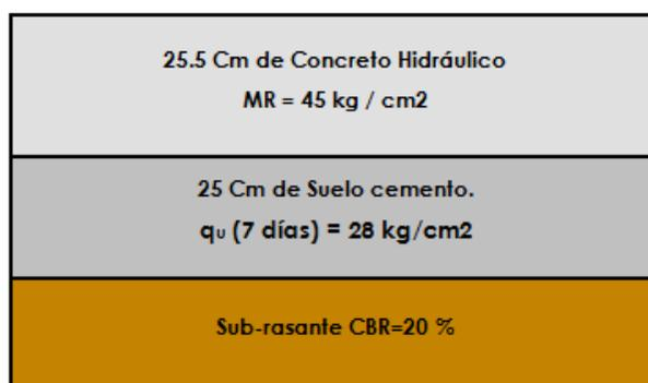
Figura 4.2 Estructura de Pavimento Boulevard Diego de Holguín tramo I
