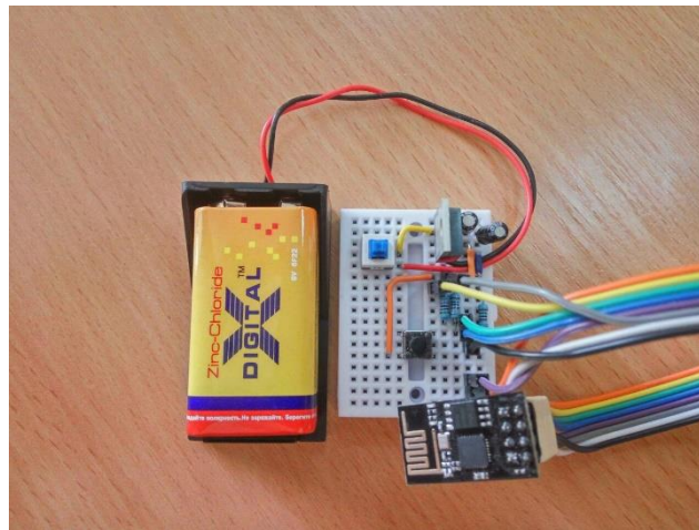
Рис. 7. Загальний вигляд тестового модулю на базі ESP-01
