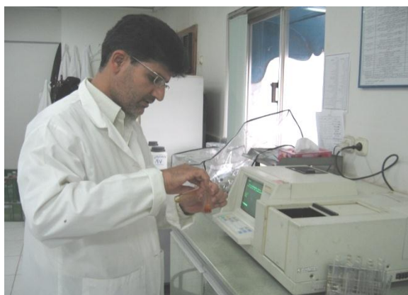
تصویر (۸) اندازه گیری مواد مغذی آب سد با اسپکتروفوتومتر دو شعاعی هیتاچی در آزمایشگاه
