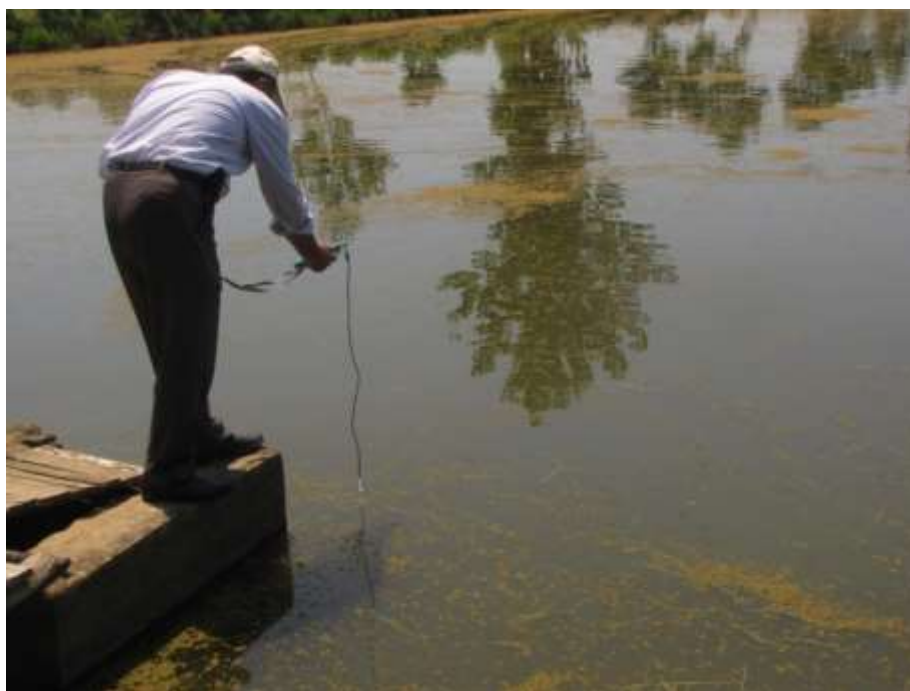
شکل ۲-۳- اندازه گیری دما، اکسیژن و pH با استفاده از مولتی متر در مزرعه پرورش ماهی گرمابی در اطراف شهر رشت
