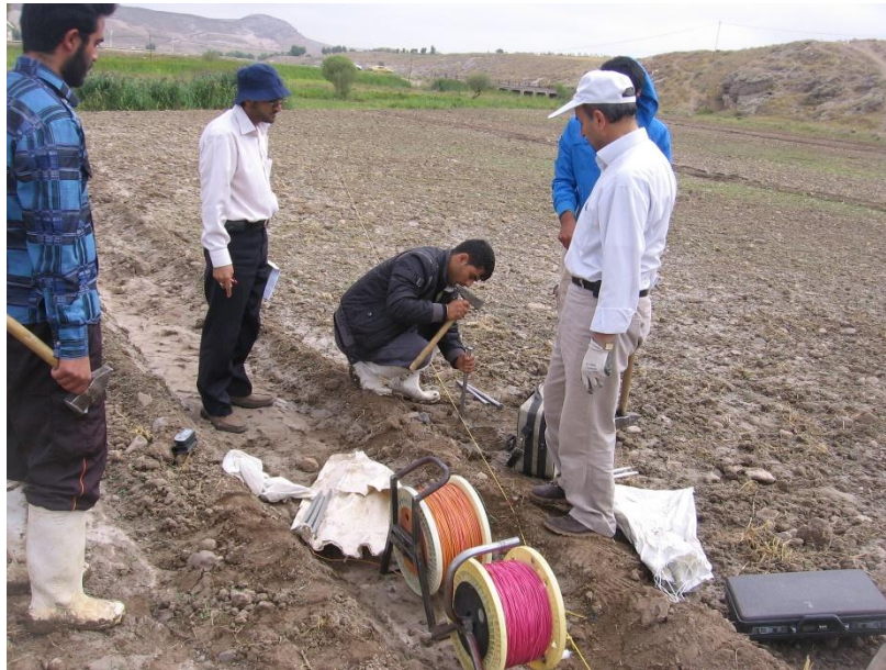
شکل ۳۱. پروفیل زنی افقی برای تعیین مقاومت ویژه الکتریکی
