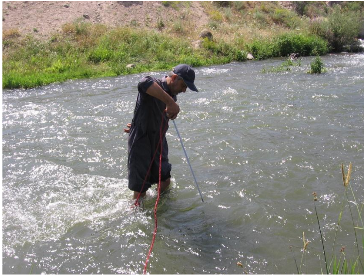
شکل ۳۳. اندازه‌گیری سطح مقطع آب رودخانه برای تعیین میزان دبی
