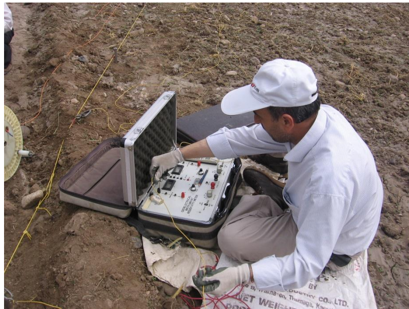
شکل ۳۲. استفاده از سونداژ الکتریکی
