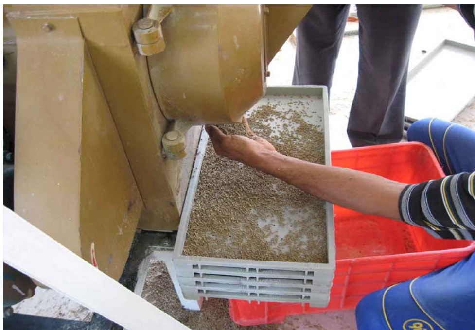
تصویر ۴- تولید غذای پلت گیاهی با دستگاه پرس پلت
