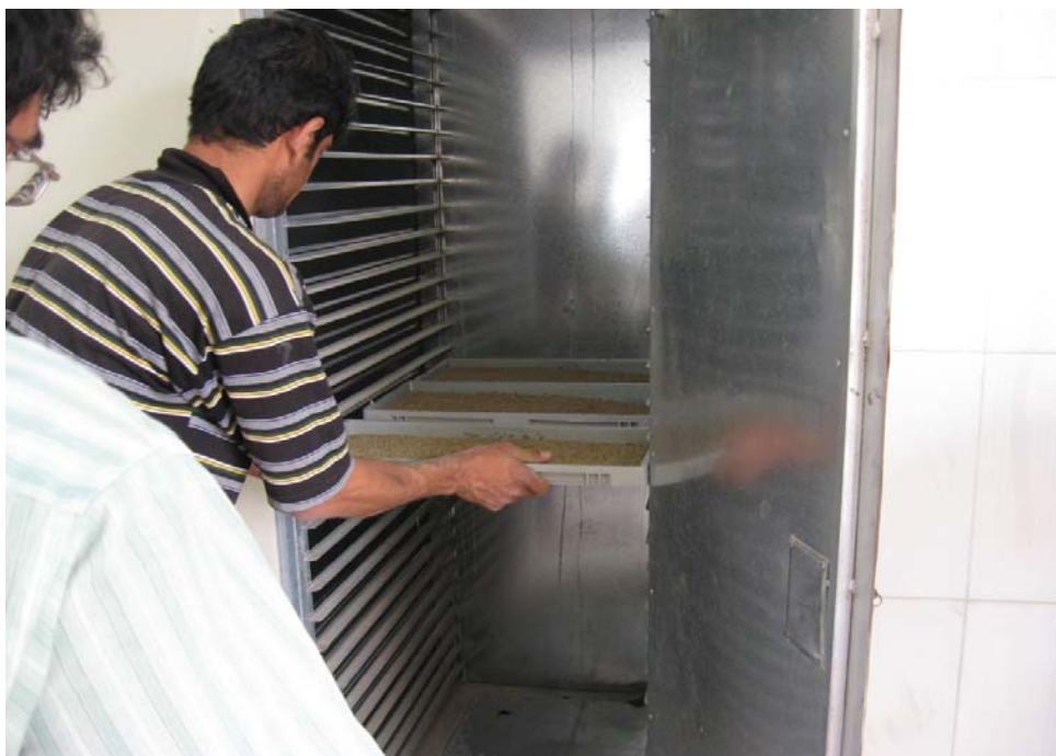
تصویر ۵- دستگاه خشک کن غذای پلت میگو
