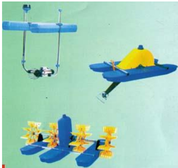
شکل ۳-۶- انواع مختلف دستگاه‌های هواده‌ی ایرجت و پدلی
