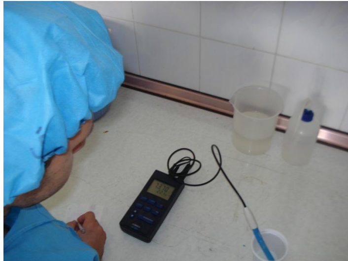
شکل ۱۸: اندازه‌گیری و ثبت فاکتورهای فیزیکی شیمیایی آب
