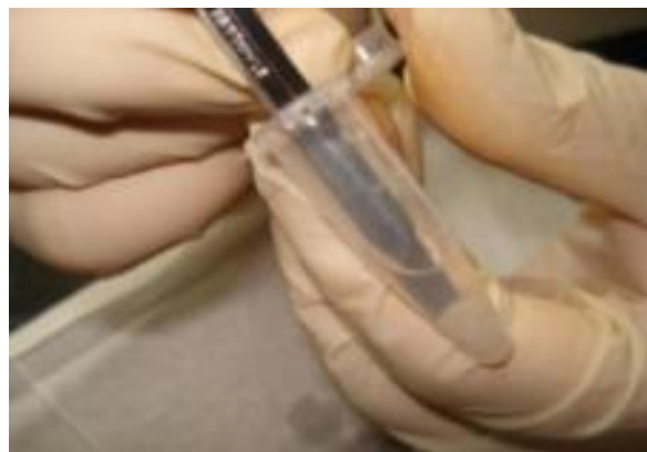
شکل ۳: خرد کردن و هموژنیزه نمودن بافت عضلانی میگوها
