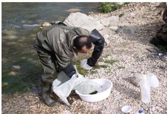
شکل ۵- روش نمونه برداری بزرگ بی مهرگان کفزی
