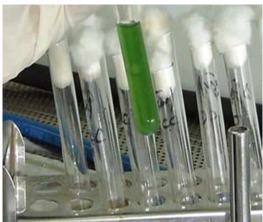
تصویر ۳-۳- آزمایش نمونه آب در تست BGB
