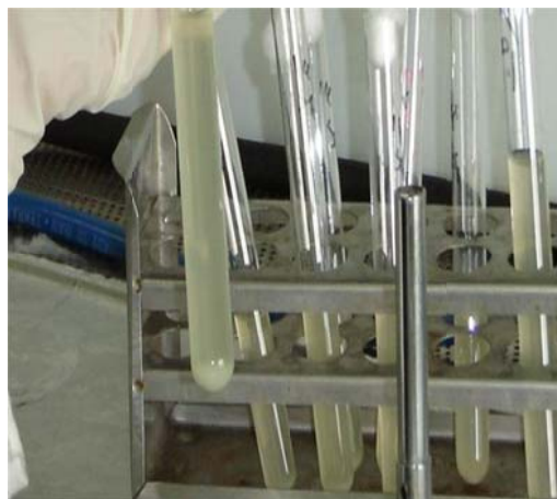
تصویر ۳-۴- آزمایش نمونه آب در تست ۹ لوله ای
