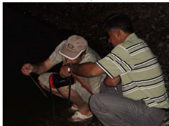
شکل ۲۳: اطمینان از صحت اندازه گیری دما با دستگاه پرتابل توسط دماسنج
