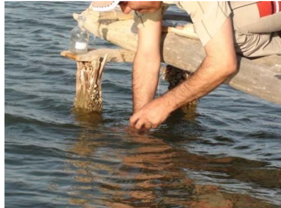
شکل ۲۱: نمونه برداری از آب استخر ها برای سنجش اکسیژن
