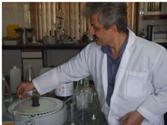
شکل ۲۶: اندازه گیری آمونیوم در نمونه های فیلتر شده با فلو آنالایزر
