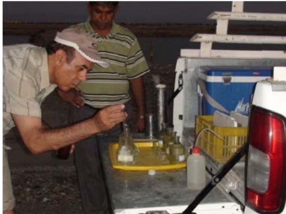
شکل ۲۲: تثبیت اکسیژن نمونه آب استخر با اسید سولفوریک غلیظ
