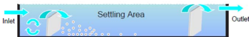
شکل ۱۶: نمای جانبی از یک حوضچه رسوب گیر
