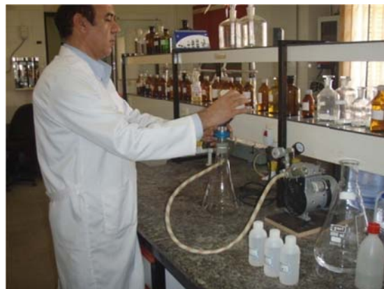
شکل ۲۵: فیلتراسیون نمونه های آب استخرها با پمپ خلا
