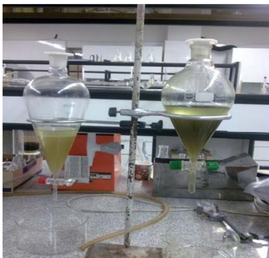
شکل ۲-۳- جدا کردن دو فاز آبی و اتیل استاتی به وسیله قیف دکانتور
