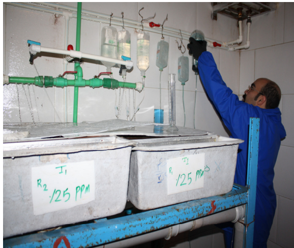
تصویر ۱۲: شیر ورودی محلول آنولیت به ترفاها در تیمارهای ۰/۲۵ ppm و ۰/۵ ppm به گونه ای تنظیم شد تا غلظت مطلوب در تمام طول مدت آزمایش به صورت مستمر حفظ گردد.
