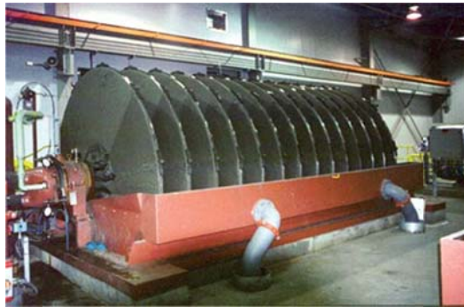
شکل شماره ۸: دیسک فیلتر Belt Filter
