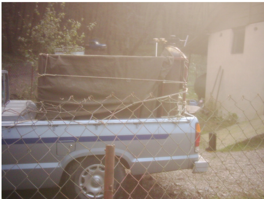
شکل ۶: وانت مجهز به چان برزنتی و کپسول اکسیژن برای انتقال مولدین صید شده
