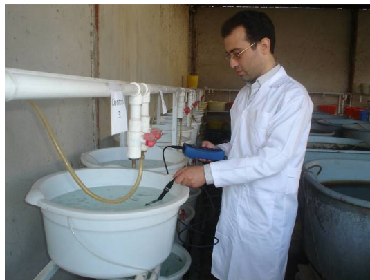
تصویر ۴ - اندازه گیری اکسیژن محلول، دما و pH آب تشنگ های حاوی ماهی
