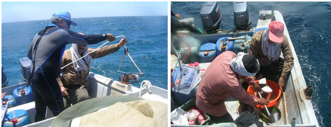
شکل ۱۹ - تصاویری از مراحل نمونه برداری بتوز بستر دریا با استفاده از دستگاه گرب
