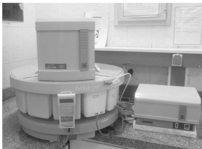
تصویر ۷- دستگاه آماده سازی بافت یا Tissue processor
