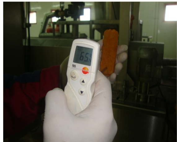
شکل ۱۳. مراحل مختلف سرخ کردن برگرها و اندازه گیری دمای مرکز محصول
