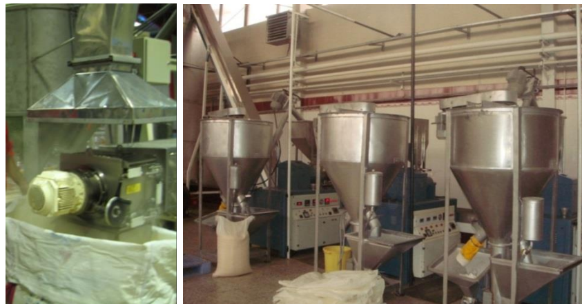
شکل ۱۸- دستگاههای اکسترودر الف- تک ماردون ب- ماردون زوج
