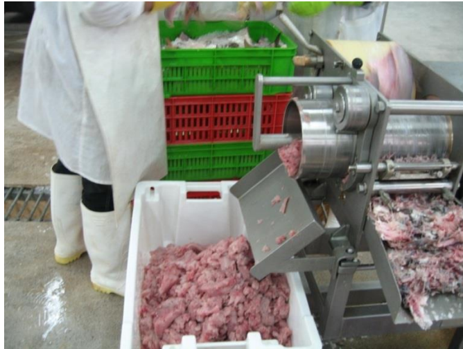
شکل ۵- جداسازی گوشت ماهی از پوست و استخوان و چرخ شدن توسط دستگاه استخوان گیر
