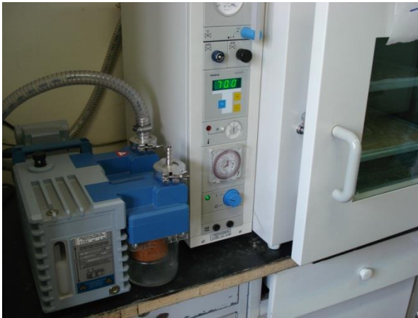
شکل ۱۵- خشک کردن پروتئین تغلیظ شده تحت خلاء
