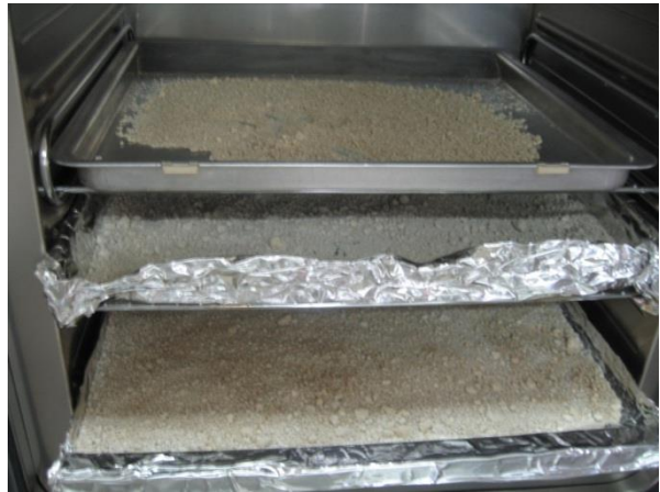
شکل ۱۵- خشک کردن پروتئین تغلیظ شده تحت خلاء
