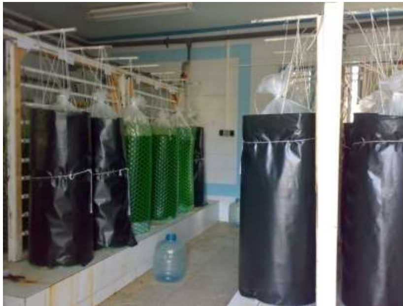
شکل ۵-۲: استفاده از پلاستیک های مشکی (دو لایه) برای جلوگیری از نفوذ نور جهت تنظیم دوره های نوری
