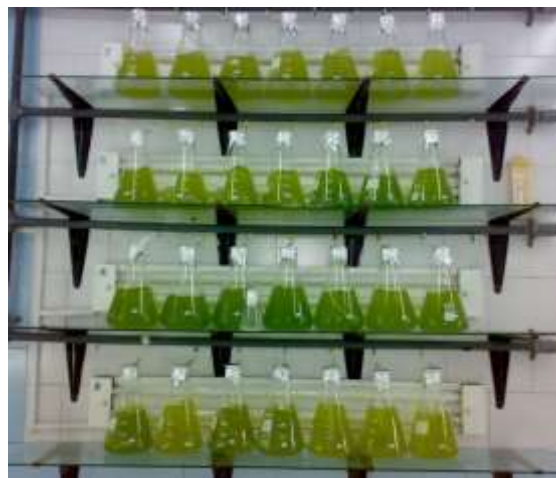
شکل ۱ - ۲: مراحل مختلف کشت و ظروف استفاده برای کشت ریز جلبک در این مطالعه (ارلن های دولیتری، بشکه های ۱۵ لیتری پلاستیکی شفاف و کیسه های پلاستیکی محافظت شده با چارچوب ساخته شده از توری پلاستیکی)
