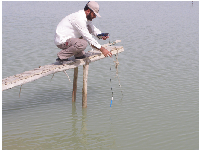
اندازه گیری pH و اکسیژن با دستگاه قابل حمل (عکس از اژدها کش)
