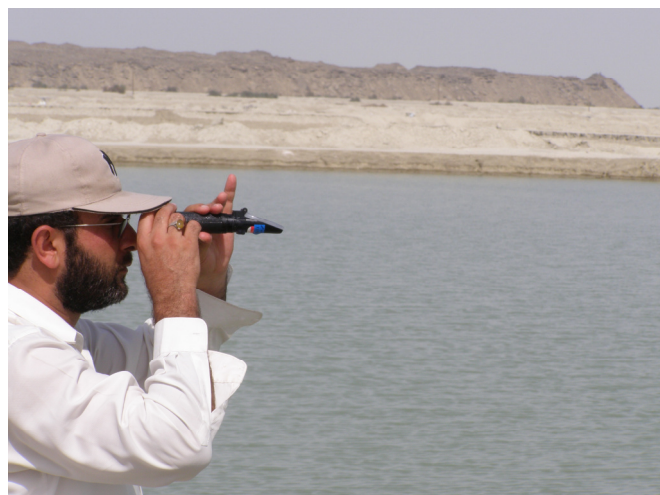
اندازه گیری شوری با رفرکتومتر چشمی (عکس از اژدها کش)
