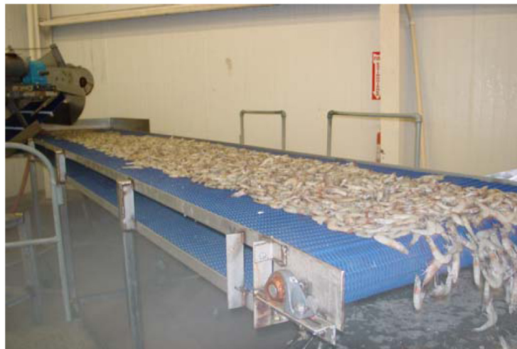
ارج کردن از بسته های پلاستیکی بر روی تسمه نقاله جهت شستشو
