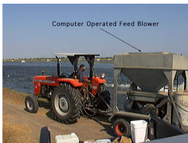
سیستم غذادهی اتوماتیک کنترل شوند با کامپیوتر در حال نصب ( مکزیک )
