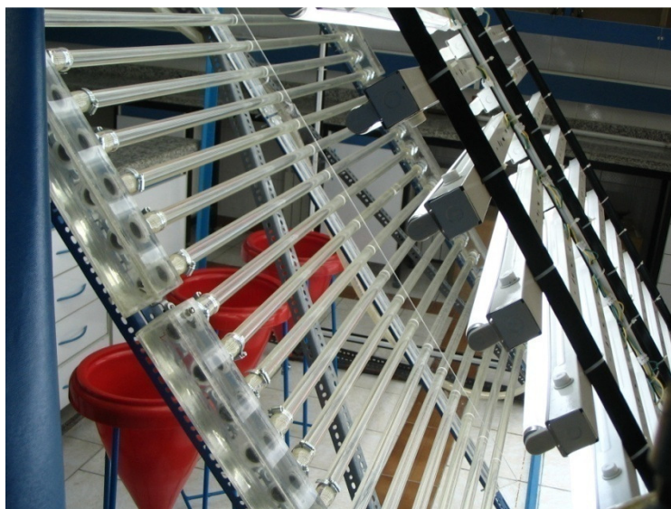
تصویر شماره ۱: بخشی از سیستم فتویوراكتور
