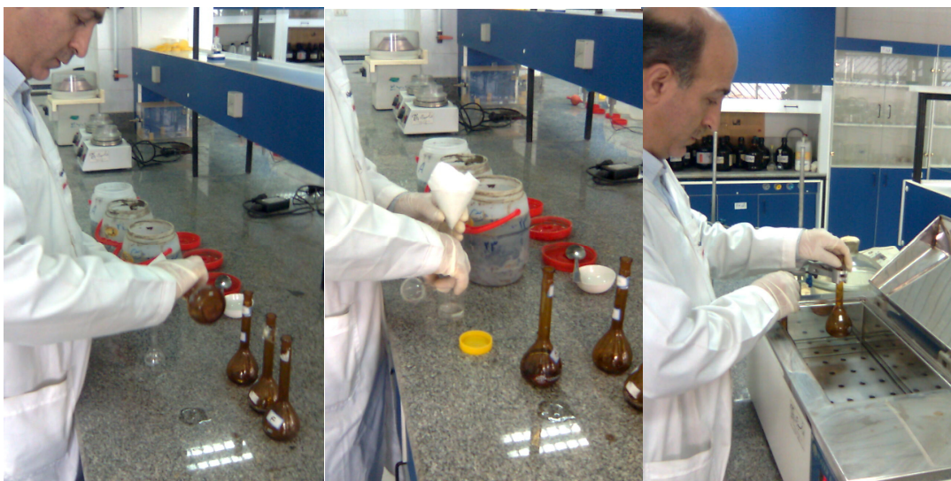
شکل ۵-۲- اضافه کردن اسید نیتریک به نمونه های خاکستر
