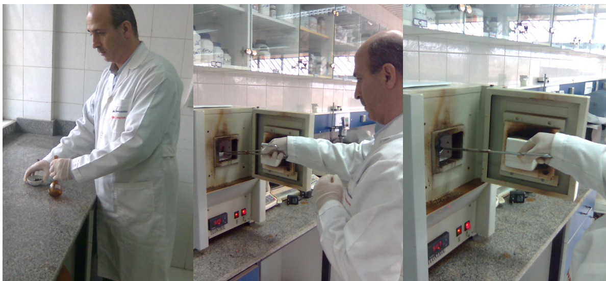
شکل ۴-۲- مراحل قرار گرفتن نمونه های عضله ماهی در کروزه (بوته چینی)
