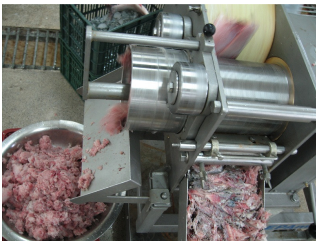
شکل ۲-۳: گوشت گیری با دستگاه استخوان گیر به روش صنعتی (Sepamatic Deboner, Germany)
