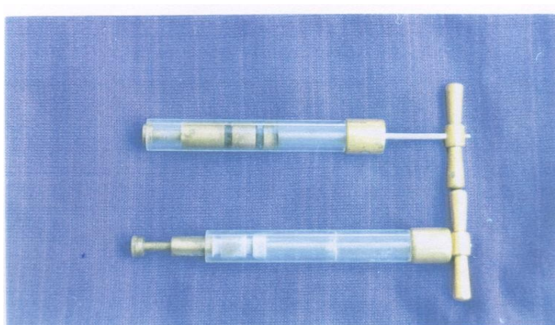
شکل ۲-۲. پی پت Stample برای گرفتن نمونه مورد بررسی
