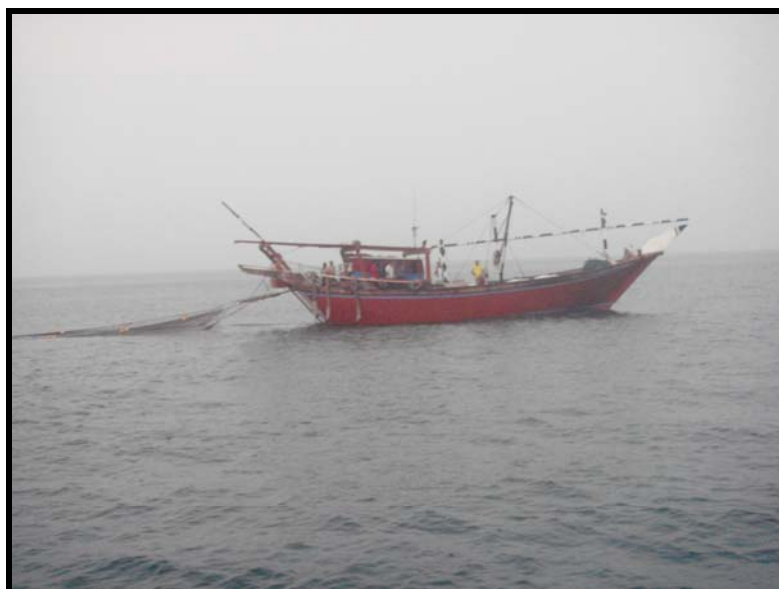
شکل ۲۲) نحوه رهاسازی تور ترال میگوی لنج
