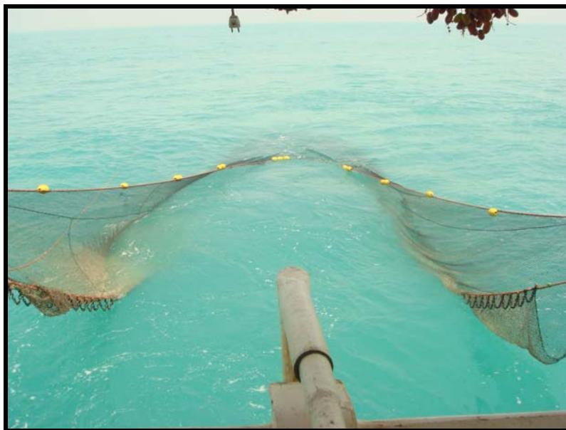
شکل ۲۳) نحوه رهاسازی تور ترال میگوی لنج
