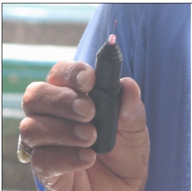
شکل ۶ - نمونه ابزار تزریق تگ به میگو
