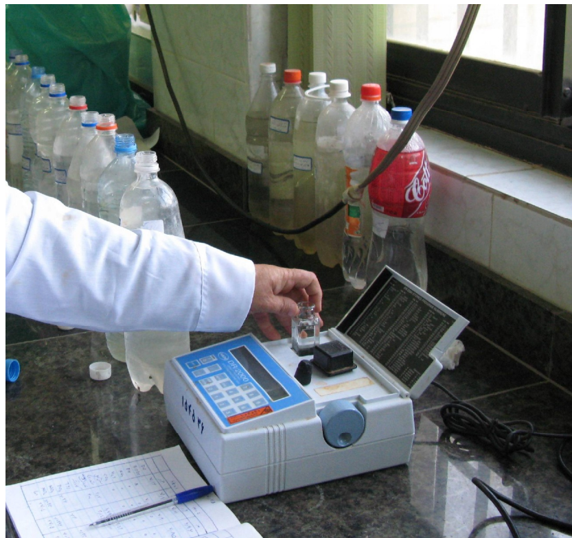
تصویر ۱۵- استفاده از دستگاه اسپکتروفتومتر برای اندازه گیری فاکتورهای شیمیایی آب
