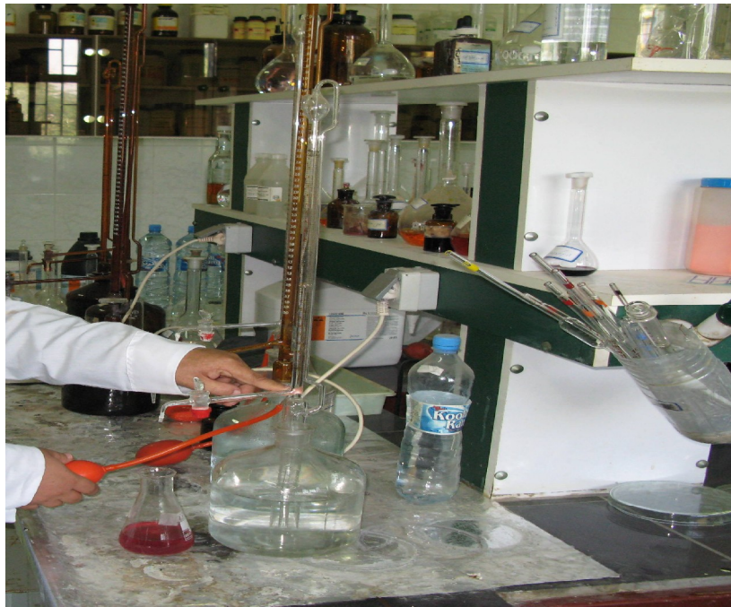
تصویر ۱۴- اندازه گیری فاکتورهای فیزیکی شیمیایی آب استخرهای پرورشی
